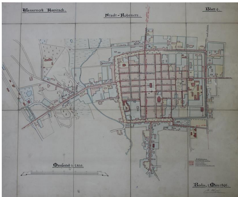
Schemat sieci wodociągowej wraz z hydrantami dla miasta Rawicza z 1896r.
